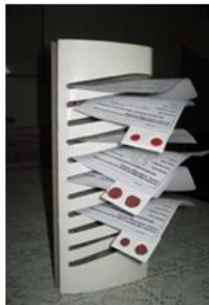
Gambar 10. Proses pengeringan spesimen ada rak pengeringan
